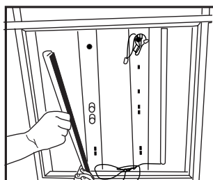
2 Installer le luminaire à DEL à l'aide du support magnétique.
