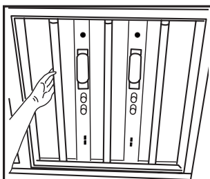
1 Retirer les tubes fluorescents et le ballast.
