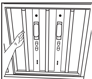
1 Desmontar los tubos fluorescentes y el balasto
