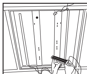
3 Instalar el controlador de LED, utilizando el soporte magnético
